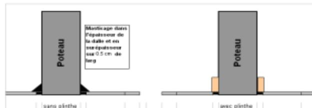
**Figure 20 : Finition sur poteaux avec ou sans plinthe**
